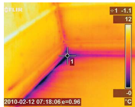
Termografi. Dette bildet er tatt ned mot hjørnet ved gulvet i et rom innvendig. Temperaturskalaen til høyre viser sammenhengen mellom farge og temperatur. Ved overgangen mellom gulv og vegg er det utettheter /dårlig isolasjon som fører til at temperaturen her er nede er 0 °C, mens resten av overflatene har høyere temperatur. Måleresultater Herredshuset i Jessheim.
